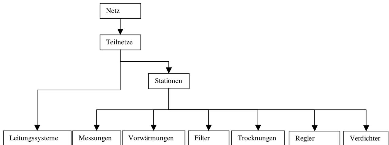
Abbildung 1: Schema der Netzkomponenten zur Beschreibung eines Erdgasnetzes
